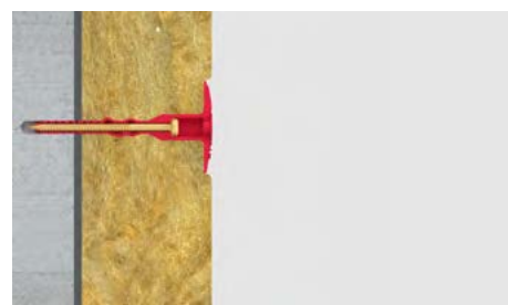
Крепление теплоизоляции тарельчатым элементом TERMOCLIP Стена ISOL MS.
